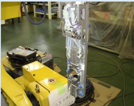
レーザーセンサで金型上のワークを確認するロボットハンド
