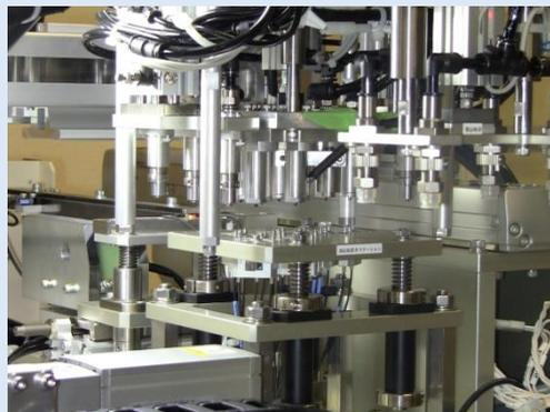
真空の圧力変化でインサートの受け渡しを確認するロボットハンド
